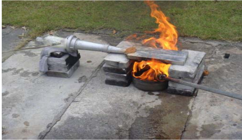
金属壳动力电池加排气管实现火烧不燃 专利（专利号：201020503600.7） → 改善电动汽车的动力电池安全设计
